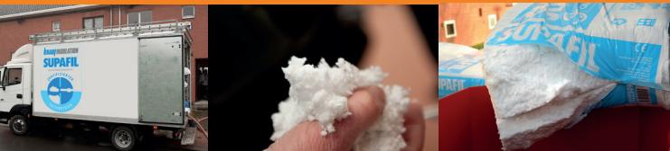
Knauf Insulation Supafil Loft Plus ist ein loser, von Natur aus nichtbrennbarer, mineralischer Dämmstoff, der ein wenig an Watte erinnert. Er wird über Schläuche direkt auf die Oberste Geschossdecke aufgeblasen.
